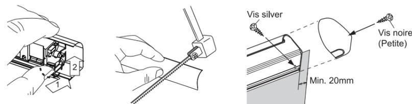
**NOTE** S'assurer de disposer d'un peu d'espace entre les clips de montage et les vis. Veiller à ne pas rayer le profilé pendant le perçage du trou.
