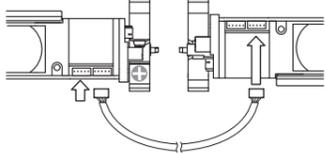
Chaque module comporte trois connecteurs de communication. Utiliser le connecteur le plus pratique pour le site d'installation.
