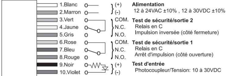
**NOTE** Lorsqu'un test d'entrée n'est pas nécessaire, régler le commutateur DIP A7 sur OFF.
