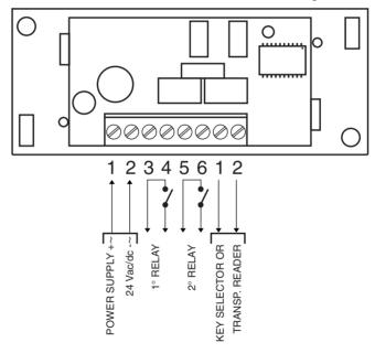
En cas de connexion en cascade de plus d'un CLAVIER, utiliser un seul câble sans jamais interrompre le blindage.
