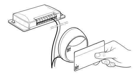
Le DÉCODEUR, qui est la partie en commun dans les deux modes de fonctionnement, assure la fonction "intelligente" du système, c'est-à-dire qu'il reçoit le code de la CARD envoyé par le LECTEUR, ou la combinaison composée sur le CLAVIER, puis il contrôle s'ils sont valables, parce qu'ils sont contenus dans sa carte de mémoire; en cas de résultat positif, la sortie correspondante est activée.
