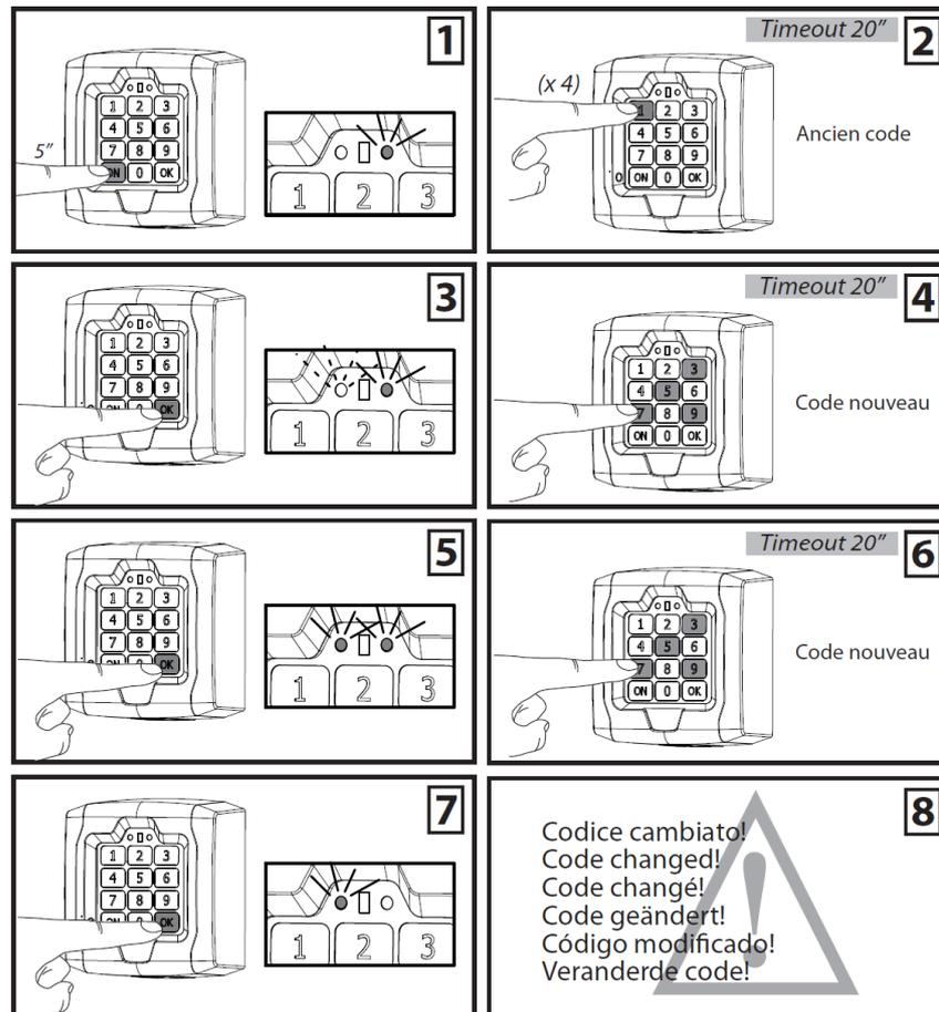
**ATTENTION:** le code consiste en une séquence de min. 4 et max. 7 chiffres (de 0 à 9). Ne pas utiliser de codes avec toutes les chiffres égaux. (es. code 2222, 3333, 4444, 0000 etc).
