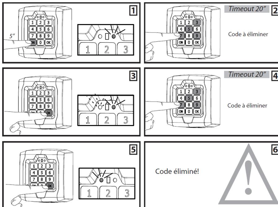
**ATTENTION :** si l'on élimine le dernier, il n'est plus possible d'activer la centrale correspondante. Pour rétablir le fonctionnement il est nécessaire d'exécuter un effacement total des codes et de répéter l'installation dès le début. Il est conseillé d'éliminer les codes des canaux non affectés (ex. code 2222, 3333, 4444, 0000 et cetera si on utilise une seule centrale).
