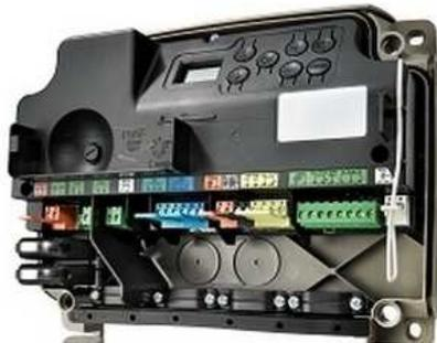
1. Au repos, l'écran digital du récepteur affiche C1. Sur le récepteur, appuyez sur le bouton PROG jusqu'à ce que l'écran affiche F0.
