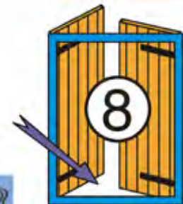
Montaje en apoyo Retardo izquierdo Salida cable izquierda
