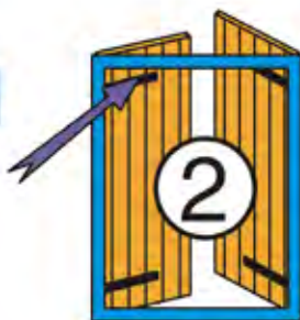
Montaje dintel Retardo derecho Salida cable izquierda
