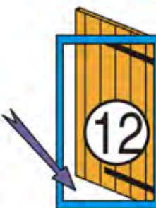
Montaje en apoyo Persiana derecha Salida cable izquierda
