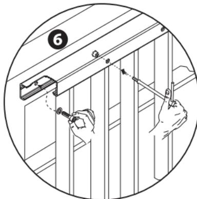
Positionner le rail au niveau des trous et le fixer à l'aide des vis filetées à tête cylindrique ⑥.
