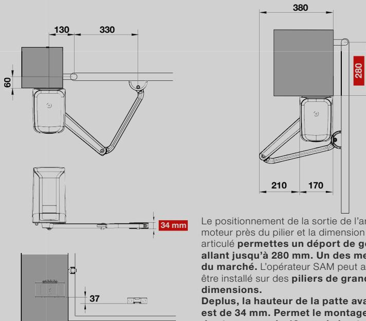
Le positionnement de la sortie de l'arbre moteur près du pilier et la dimension du bras articulé **permettent un déport de gonds allant jusqu'à 280 mm. Un des meilleurs du marché.** L'opérateur SAM peut ainsi être installé sur des **piliers de grandes dimensions**. **Deplus, la hauteur de la patte avant qui est de 34 mm. Permet le montage sur des traverses de 40 mm de hauteur.**
