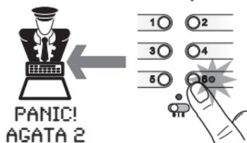
Appuyer pendant au moins 2 secondes sur le bouton 6; le poste émet un signal sonore et la led rouge s'allume pour confirmer que le signal Panique a bien été envoyé au concierge avec le numéro de l'appelant. La led du poste doit rester allumée jusqu'à ce que le concierge rappelle l'utilisateur.
