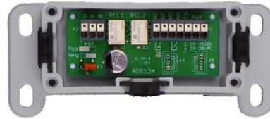
Der AOS 124 wurde als universell einsetzbare Auswertung für die am Markt gängigen optoelektronischen Schließkantensysteme entwickelt.
