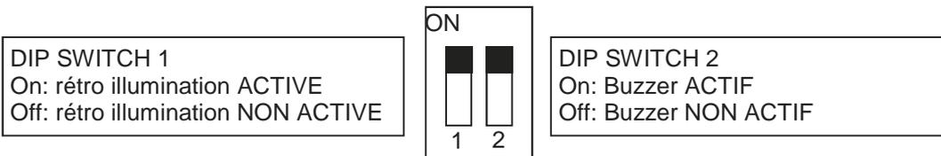
En cas de fonctionnement à batterie, une fois terminée la programmation, il est conseillé si possible de mettre les deux dip-switch en position OFF pour permettre une épargne d'énergie majeure et augmenter ainsi la durée de vie de la batterie.
