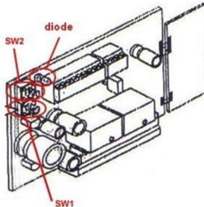
1. Drücken Sie auf der Empfängerkarte die Programmier Taste SW1. Die Diode des Empfängers blinkt. Lassen Sie die Taste los.
