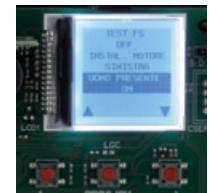
**ITALIANO** La centralina a display grafico (128 x 128 pixel) è stata aggiornata con la funzione di Multi Decodifica che permette l'uso dei sistemi di radio comando tramite la semplice sostituzione del modulo di memoria codici da **S449** a **S504**, da **S486** a **S508** e vice versa. La presenza di questa funzione sarà indicata dal bollino 'Multi Decoding' applicato sia sull'imballo del prodotto che sull'istruzione d'installazione ed uso.
